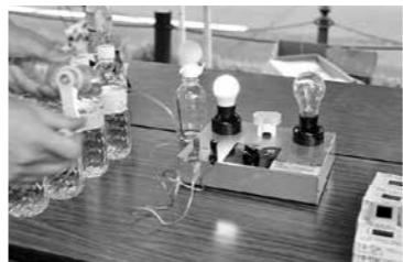
▲手回しの発電装置。参加者は白熱球とLEDをそれぞれ光らせ、LEDの方が少ない力で明るく点灯することを体感していました
