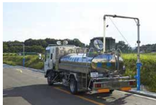
写真 仙台市型給水車注水補給設備
