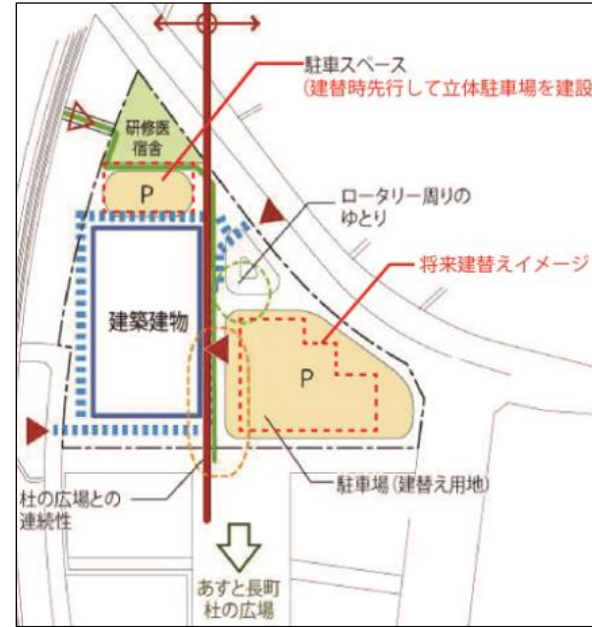
↑ 将来の建て替えスペースを平置駐車場として整備した仙台市立病院の例
