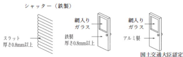
1.7 図6 防火戸（防火設備）の例
