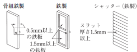
1.7 図5 防火戸（特定防火設備）の例
